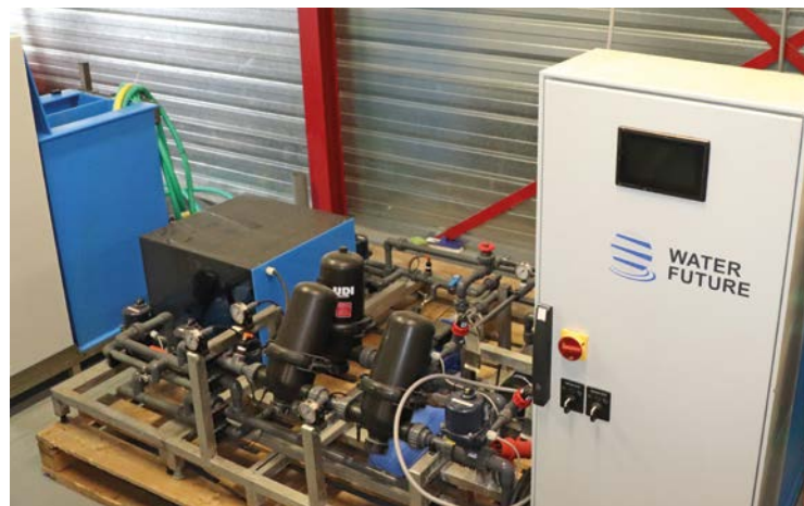
De testopstelling van de Rencon-membraanscheidingsinstallatie zoals die vanaf 1 januari 2025 draait bij mestverwerker Merensteyn in het Limburgse Ysselsteyn.
