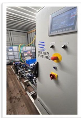
Figuur 5 Proefopstelling Water Future ED opstelling bij Merensteyn
