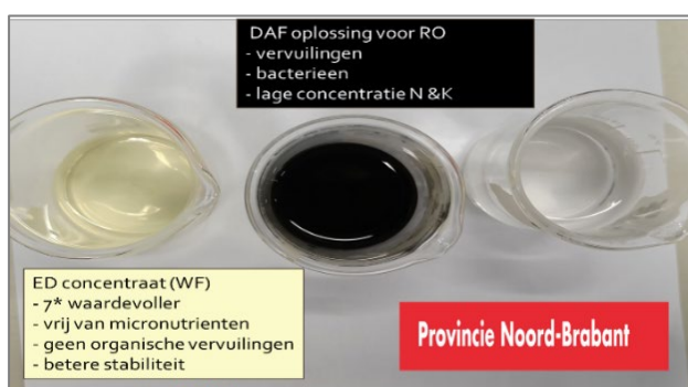
Figuur 3 Foto van ED concentraat (links) van het RENCON-proces en de dunne fractie/DAF oplossing (midden) welke momenteel voor RO gebruikt zou worden.
